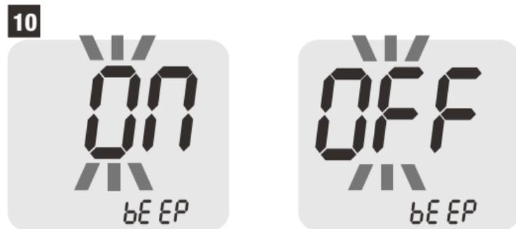
**10. Ligando ou desligando o aviso sonoro:** O glicosímetro está configurado com o aviso sonoro ligado. Para modificar para desligar, aperte “<” ou “>” até que “OFF” (desligado) apareça, então aperte ‘
