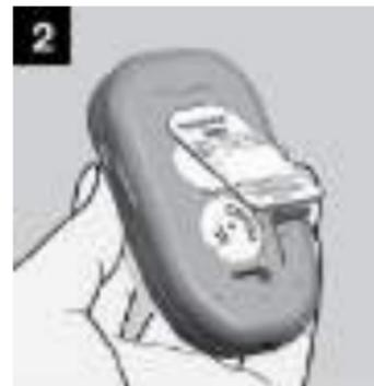
2. Abra a tampa do compartimento de baterias na parte traseira do glicosímetro e remova as baterias antigas, substituindo por 2 novas baterias CR2032. Tenha certeza de alinhar o lado “+” voltado para cima. Uma vez no lugar, coloque a tampa da bateria novamente no glicosímetro.
