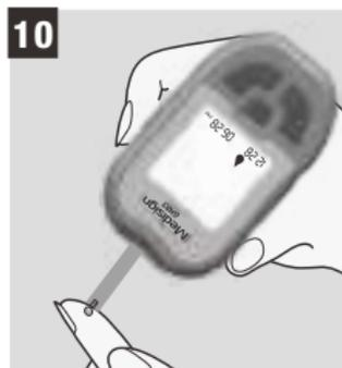
10. Segure a ponta da tira de teste para pingar o sangue, a tira de teste automaticamente puxará o sangue para dentro da tira. Quando a quantidade de sangue for suficiente, o glicosímetro emitirá um som e iniciará uma contagem a partir de 6(seis) segundos. Depois de seis segundos seu resultado na tela LCD.
