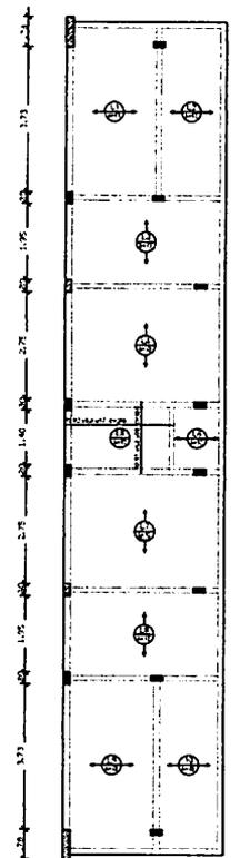
Armação positiva das lajes do pavimento Nivel 320
